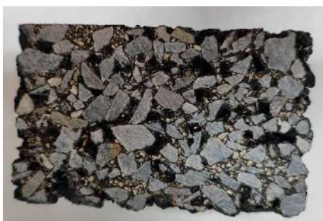
Figura 2: Mezcla asfáltica BBTM 11B CORNEANA 02C T3501
