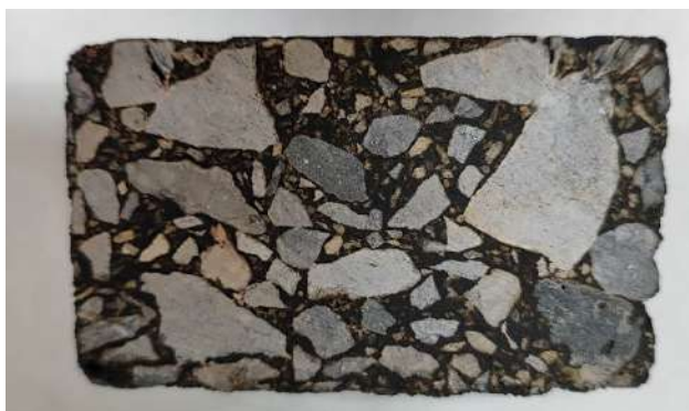
Figura 2: Mezcla asfáltica AC22 BASE 50/70 G CALIZA 04C04AS A3730R
