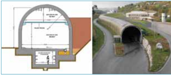
Figura 12: Sección del túnel de ensayos.
