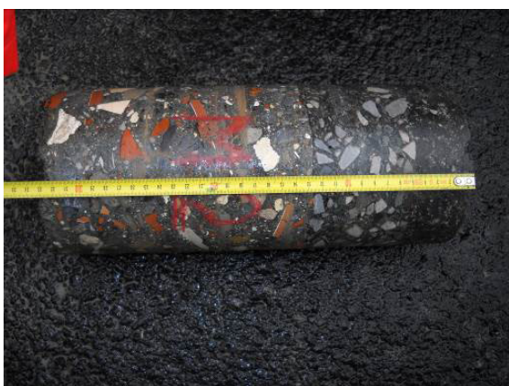
Testigo (90 días) de GC con ARM y mezcla bituminoso (intermedia y rodadura)
